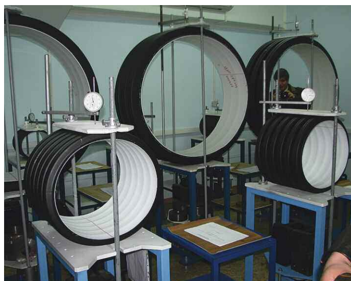
Рис. 6. Испытания на кольцевую гибкость
