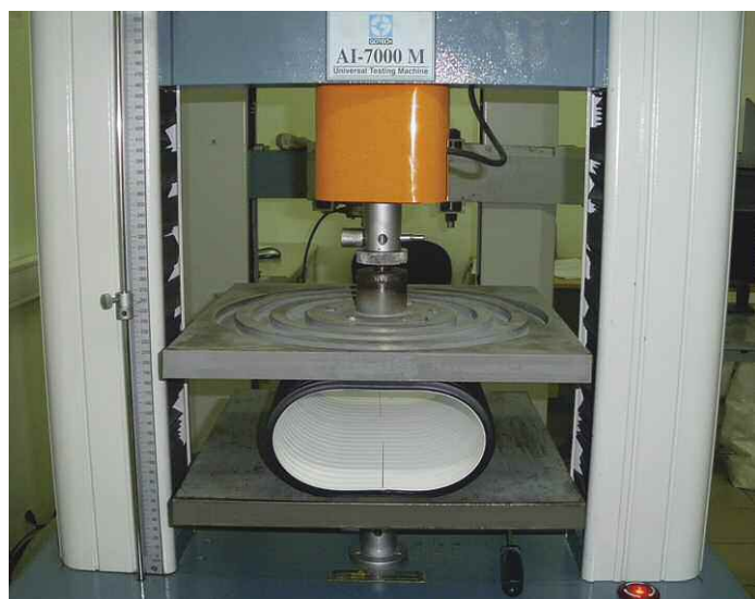
Рис. 5. Испытания на кольцевую жесткость
